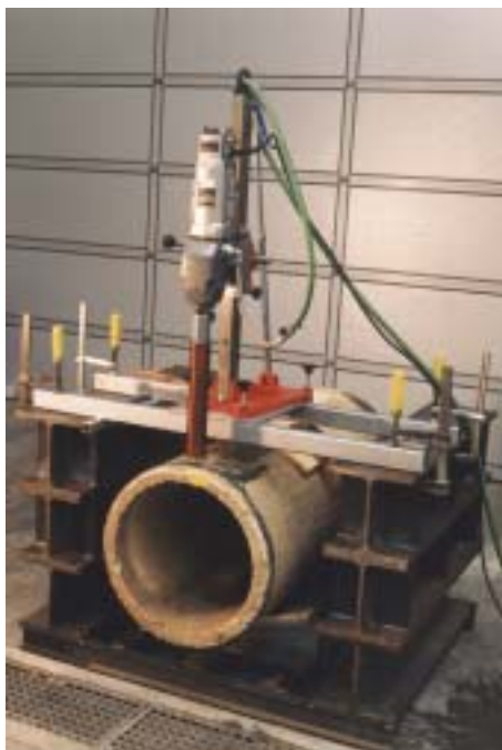
Figur 1.6 Kerneboringsudstyr. Opstillingen sikrede, at udboringen blev foretaget vinkelret på betonrørens overflade, samt at både boremaskine og betonrør blev fastholdt under udboringen.
