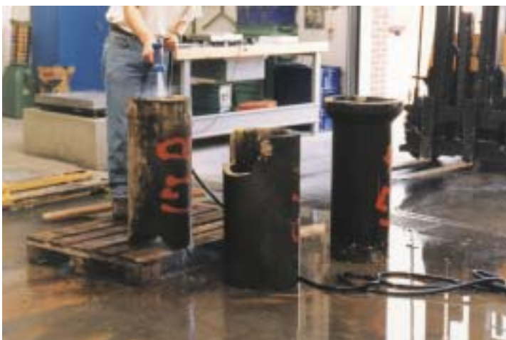
Figur 1.1 Før udboringen af prøveemner blev betonrørene spulet rene for slam og sand.
