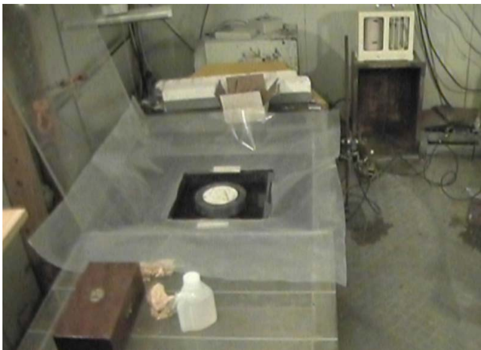
Figur 7: Vindtunnel, hvori den støbeklare form er placeret. For at undgå betonspild omkring vægten, er området tildækket med plast. Til højre for tunnelen ses tryktransducerne monteret i stativ.
