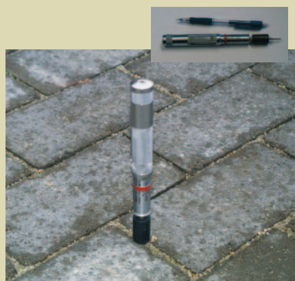
Modificeret penetrationsmåler. Vha. en fjeder måles den kraft, der skal anvendes for at presse spidsen så langt ned, at den sorte cylinder lige netop støder på stenen.
