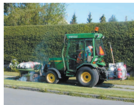
Ukrudtsgasbrændere er det mest udbredte redskab til termisk bekæmpelse af ukrudt.
